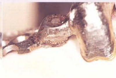
4-7, 8 各種アタッチメント接合部を重複レーザー法にて、レーザー溶接する
