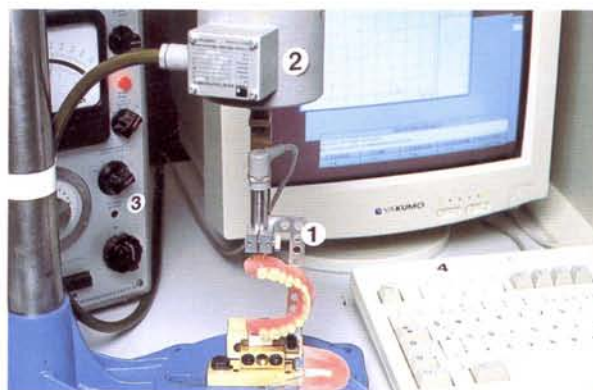
図6 上顎無口蓋総義歯の機能辺縁および歯列を伴う歯槽頂部。口蓋板を取り外した後で荷重装置にかけて、横走方向の変化を測定行う
