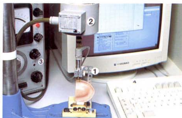
図7 取り外した口蓋板に対して、横走寸法変化の測定を行う
