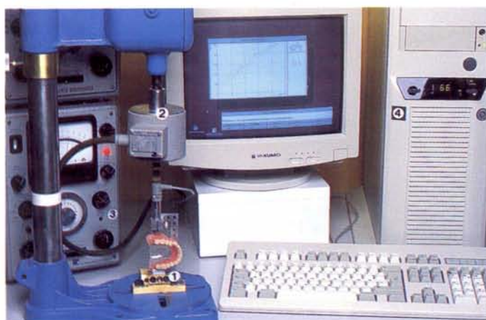
図1 実験装置の配置。①誘導方向指示装置を伴う固定装置(W 0.5 T : Hottinger-Baldwin)および中心位荷重軸、②応力測定容器付き荷重装置、③搬送周波数測定増幅器、ヒステリシス曲線(DIA-DAGO)
