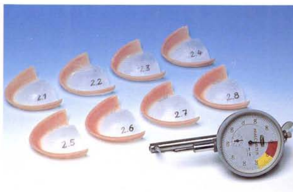
図3 取り外された口蓋板および精密測定ゾンデ(レンファート精密メーター)。それぞれの試験体の厚み、プロファイルを記録するための準備が整った状態
