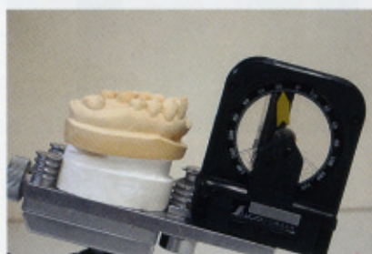
図13~15 Simplant 画像上では咬合平面を基準面(02)としていることから、雲台上の側方的位置関係を修正する必要が生じる。リングマシンの雲台を調整し咬合平面を設定した時に、傾斜角がほぼ15°となった。さらに上顎左側中切歯部ステント唇面切端側3分の1が1.5mmのスパイラルポイントと平行となり咬合平面に対して90°を示した。これにより設定された咬合平面の正当性が立証された。
